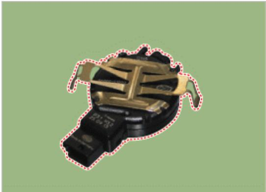
4. 雨传感器模块通用粘合剂粘附在挡风玻璃上。更换挡风玻璃时，从现有的挡风玻璃上拆卸雨传感器模块，并在新的挡风玻璃上安装雨传感器模块。
